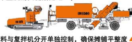
添加新料与复拌机分开单独控制，确保摊铺平整度
