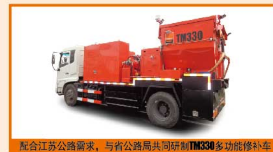
配合江苏公路需求，与省公路局共同研制TM330多功能修补车
