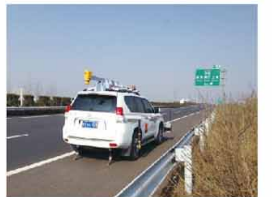
英达检测车数据显示：润扬大桥施工近5年车辙仍不足1cm
