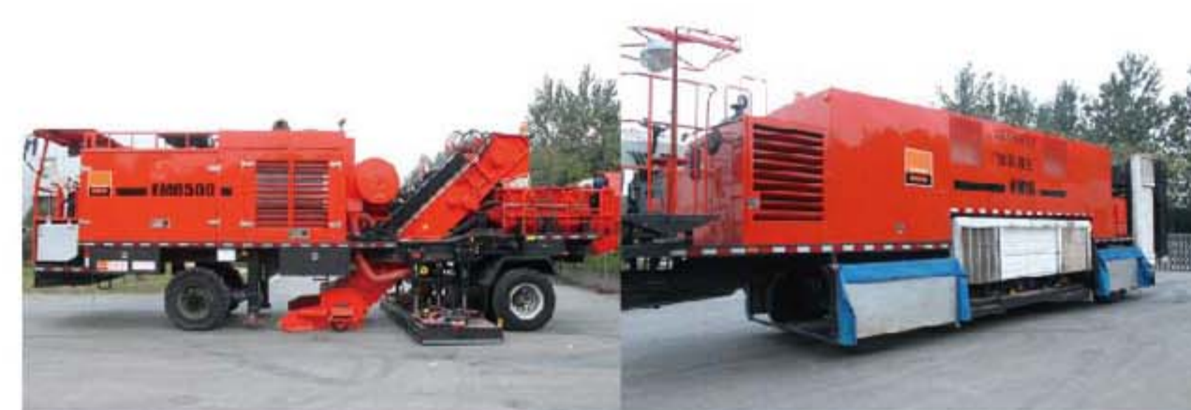
英达机组各台设备具有自行功能,施工时无需牵引车牵引
